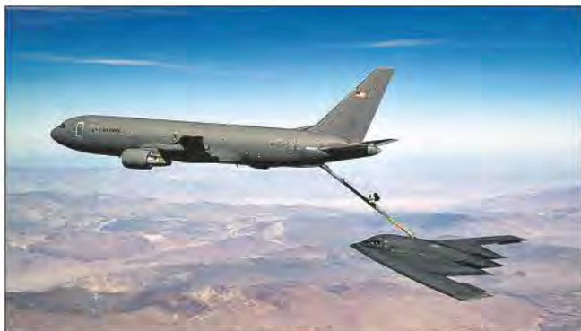
ТЗС KC-46A «Пегас» в ходе испытаний системы дозаправки топливом различных типов самолетов с помощью телескопической топливозаправочной балки в хвостовой части (сверху вниз: истребителя A-10 «Тандерболт», истребителя F-22A «Раптор», стратегического бомбардировщика B-2A «Спирит»)
