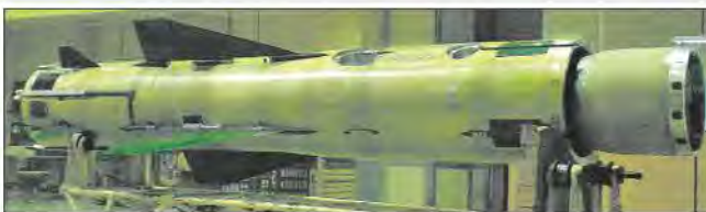
Крылатая ракета «Брамос» в сборочном цехе
