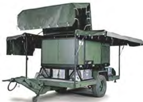
Элементы пункта водоснабжения: мобильная станция WTC 1600, размещенная на прицепе (слева), и станция очистки воды в 20-футовом контейнере
