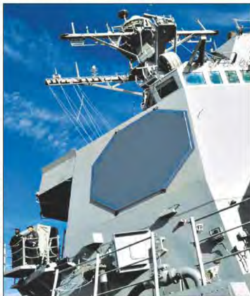
Внешний вид антенной системы радиолокационных станций: AN/SPY-1 на эсминце УРО типа «О. Бёрк» мод. 2А (слева); AN/SPY-6(V)1 на однотипном эсминце мод. 3 (справа)
