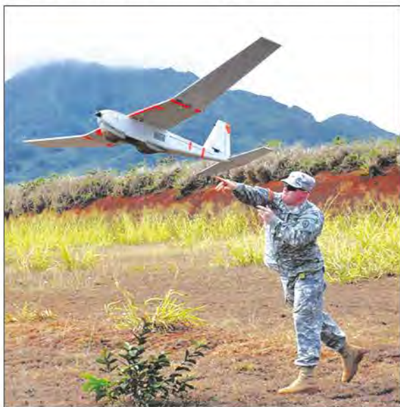
Запуск с руки БПЛА RQ-20A «Пума», оснащенного электрическим двигателем и водонепроницаемым комплектом электронно-оптических сенсоров для ведения разведки и наблюдения
