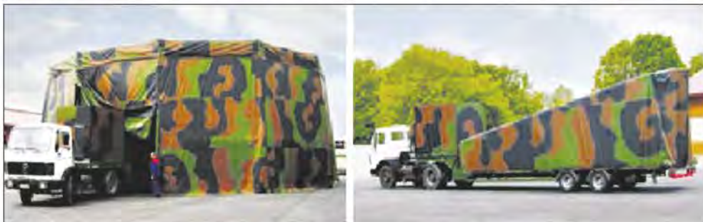
Мобильный многоцелевой ангар фирмы «Лосбергер» в боевом и походном положении
