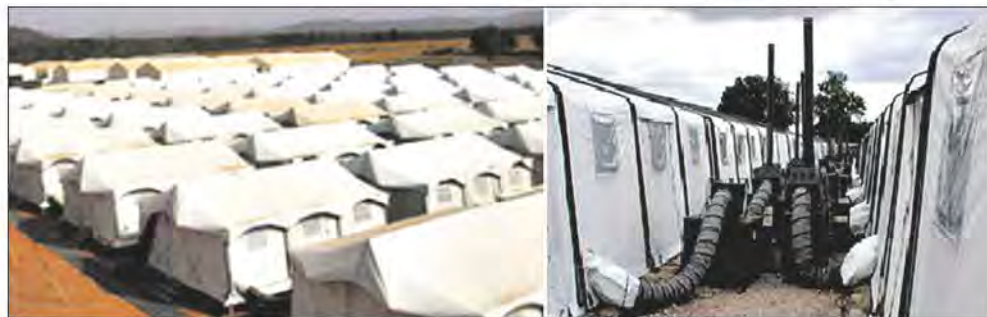
Палатки типа «Универсальная-2» для размещения подразделений в полевых условиях (справа видна фильтровентиляционная установка)
