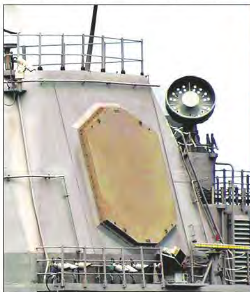
Внешний вид антенной системы радиолокационных станций: AN/SPY-1 на эсминце УРО типа «О. Бёрк» мод. 2А (слева); AN/SPY-6(V)1 на однотипном эсминце мод. 3 (справа)
