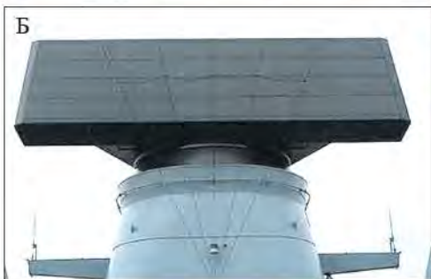
Внешний вид модульных АФАР многофункциональных корабельных РЛС: А – «Си Файр-500»; Б – «Смарт-Л»; В – EL/M-2248 MF-STAR
