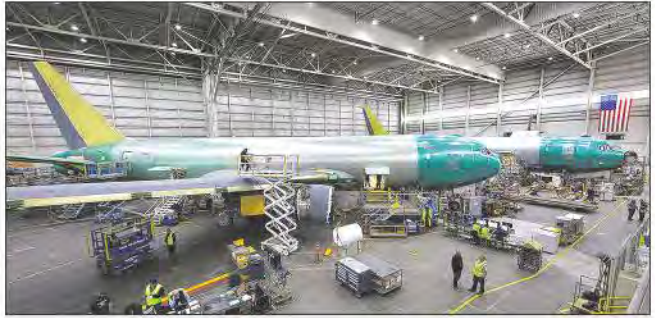
Сборка транспортно-заправочных самолетов КС-46А на предприятии корпорации «Боинг»
