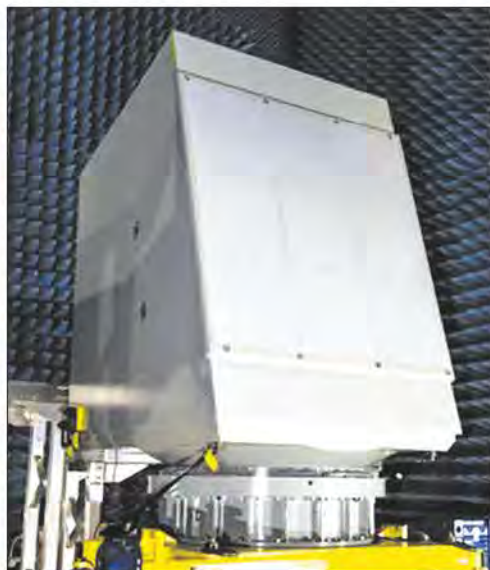
Антенная система станции AN/SPY-6(V)2 на опорно-поворотном устройстве на ракетном полигоне Баркинг-Сандс (слева) и в безэховой камере (справа)
